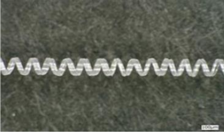
圖 2：Solotex Eco-Hybrid 捲曲紗的結構
